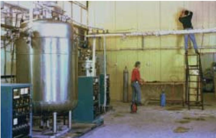
*Fermenteur à Al Hakam (IRK) permettant de produire des vaccins, mais aussi des toxiques B de combat. Une entreprise suisse, entre autres, de construction d'installations avait livré de gros fermenteurs à l'Irak en 1985 et 1986. (Source: Photo UNSCOM)*
